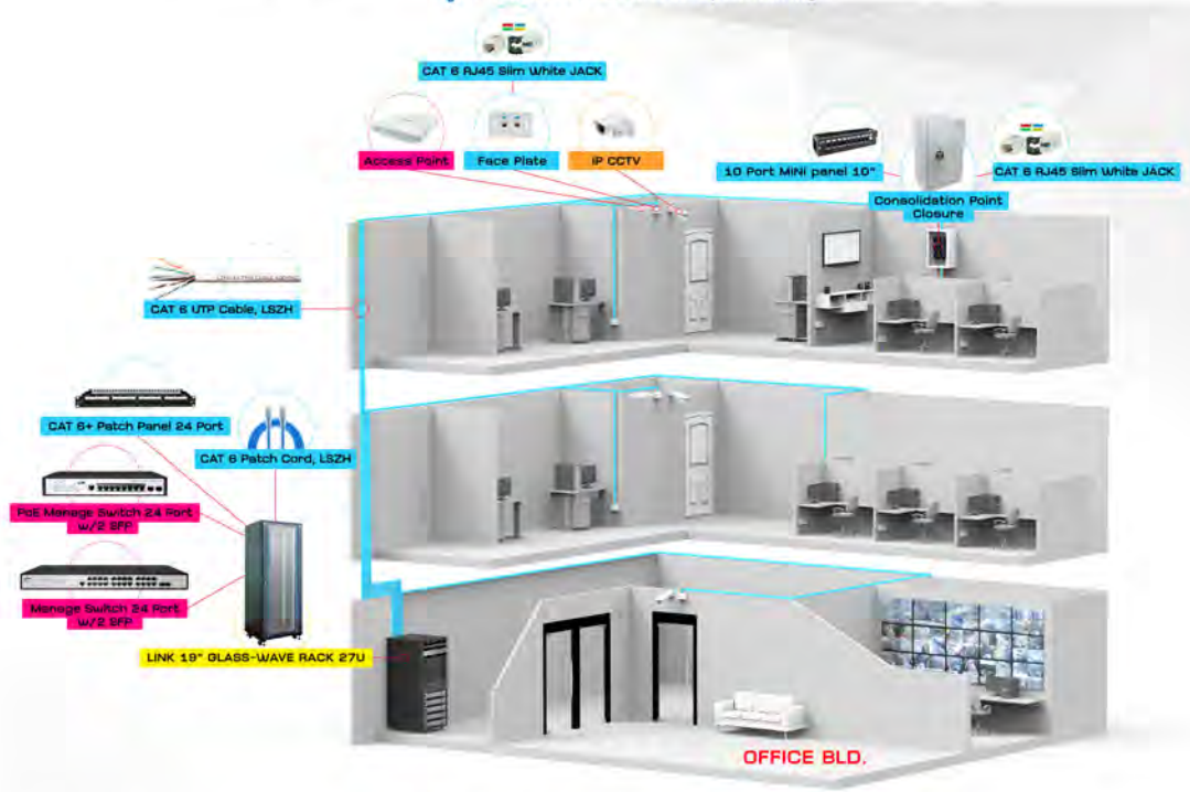
รูปที่ 2 แสดงการเชื่อมต่อ ระบบ LAN Open Cabling โดยมีจุด CP
