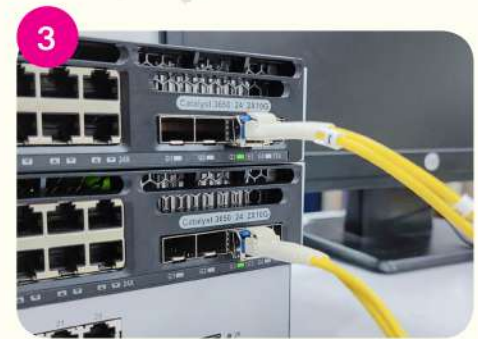
สถานะของพอร์ตบน Cisco C3650 ติด แสดงการเชื่อมต่อทางด้าน Physical ไม่มีปัญหา
