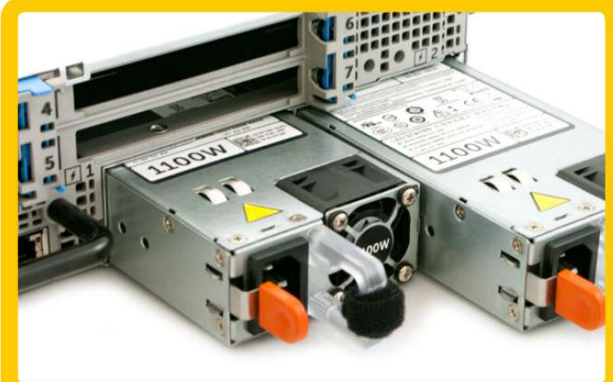
ภาพที่ 3 ระบบจ่ายไฟฟ้าสำรองสำหรับ Server
