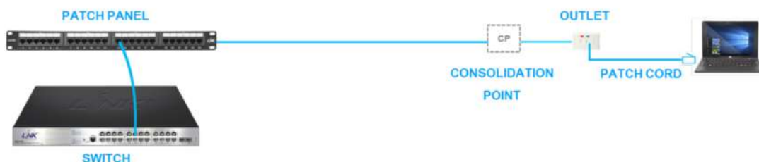
*ภาพแสดง การติดตั้งระบบสายสัญญาณแบบ Open Cabling System
